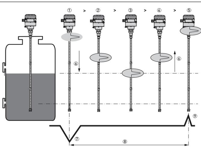
Электронный преобразователь сигналов уровнемера AKS 4100/4100U излучает высокочастотные электромагнитные импульсы малой интенсивности с периодом равным одной наносекунде, которые движутся вдоль измеряющей части уровнемера (троса или коаксиального кабеля) вниз к поверхности жидкости.
